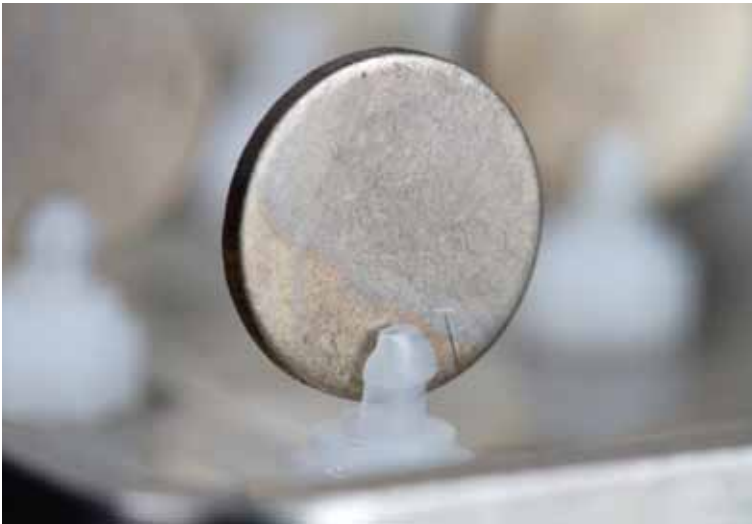
Titaniumschijf vastgeklemd in de deksel van het onderzoeksmodel
